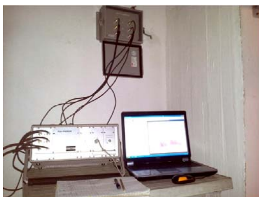
Figura 5 Echipament pentru măsurarea activității on-line (Analizor PD, cutie cu terminale, laptop cu software dedicat)
