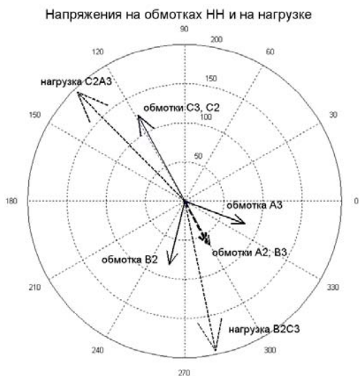
Рис. 3. Напряжения на обмотках НН и на нагрузке при замыкании одной из фаз нагрузки
