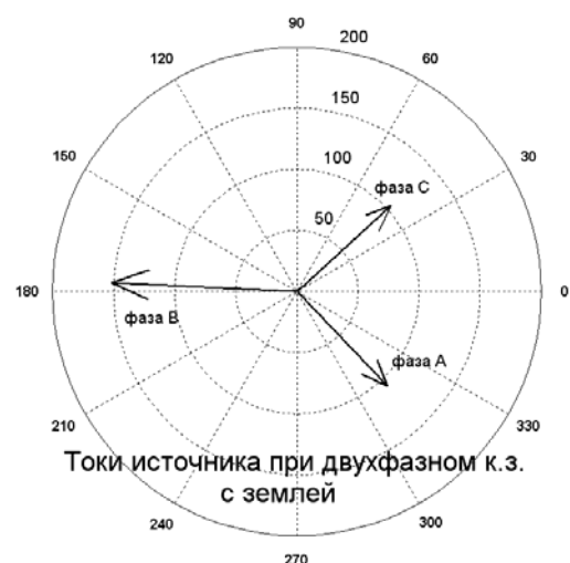
Рис. 10. Токи источника при двухфазном к.з. с землей
