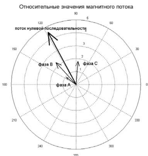
Рис. 5. Относительные значения магнитных потоков при ОКЗ нагрузки и неравноплечих обмотках, составляющих зигзаг
