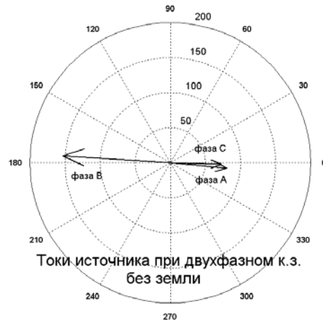
Рис. 8. ВД токов источника при двухфазном кз без земли и при симметричной нагрузке
