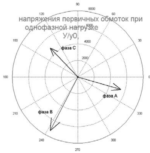
Рис.6. Напряжения первичных обмоток при при однофазной нагрузке
