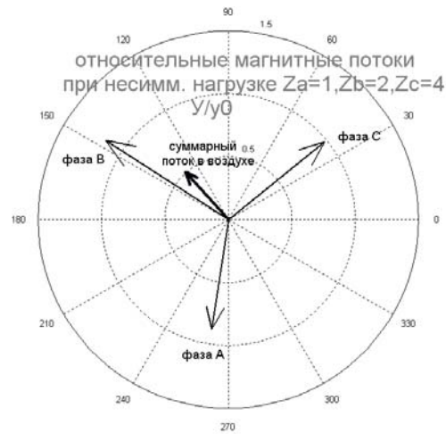
Рис.11. Относительные магнитные потоки при несимметричной нагрузке
