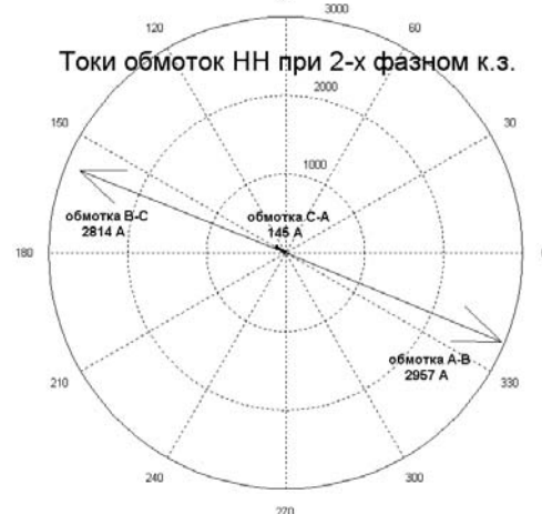
Рис.21. Токи обмоток НН при двухфазном КЗ
