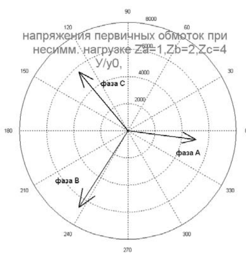
Рис. 8. Напряжения первичных обмоток при несимметричной нагрузке
