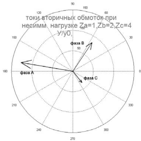
Рис. 10. Токи вторичных обмоток при несимметричной нагрузке
