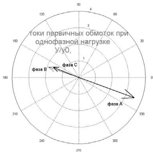
Рис. 5. Токи первичных обмоток при однофазной нагрузке
