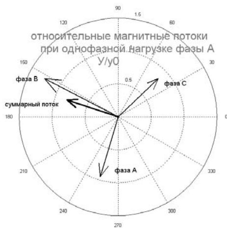
Рис.7. Относительные магнитные потоки стержней при однофазной нагрузке
