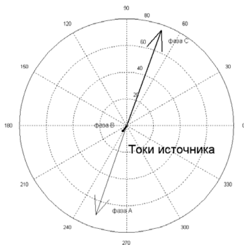
Рис. 15. Токи источника питания при ОКЗ на стороне НН
