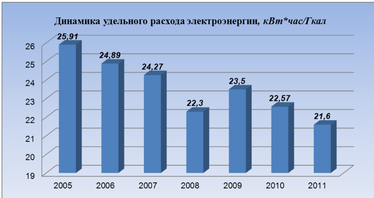
Рис 5. Динамика удельного расхода электроэнергии на транспортировку тепловой энергии
