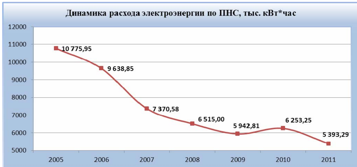
Рис 2. Динамика расхода электроэнергии по ПНС, на которых были установлены преобразователи частоты.
