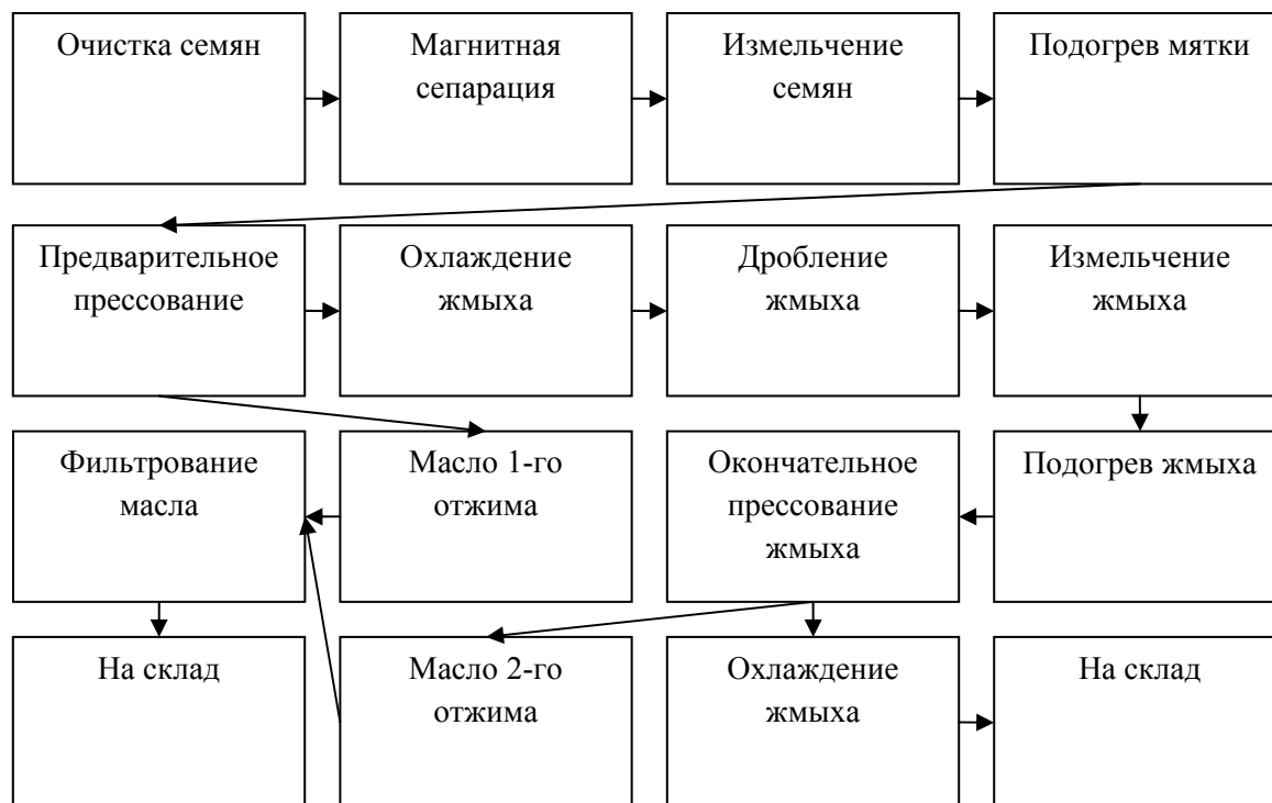
Рис. 6. Технологическая схема работы линии производства рапсового масла М8-МКИ (рапс)
