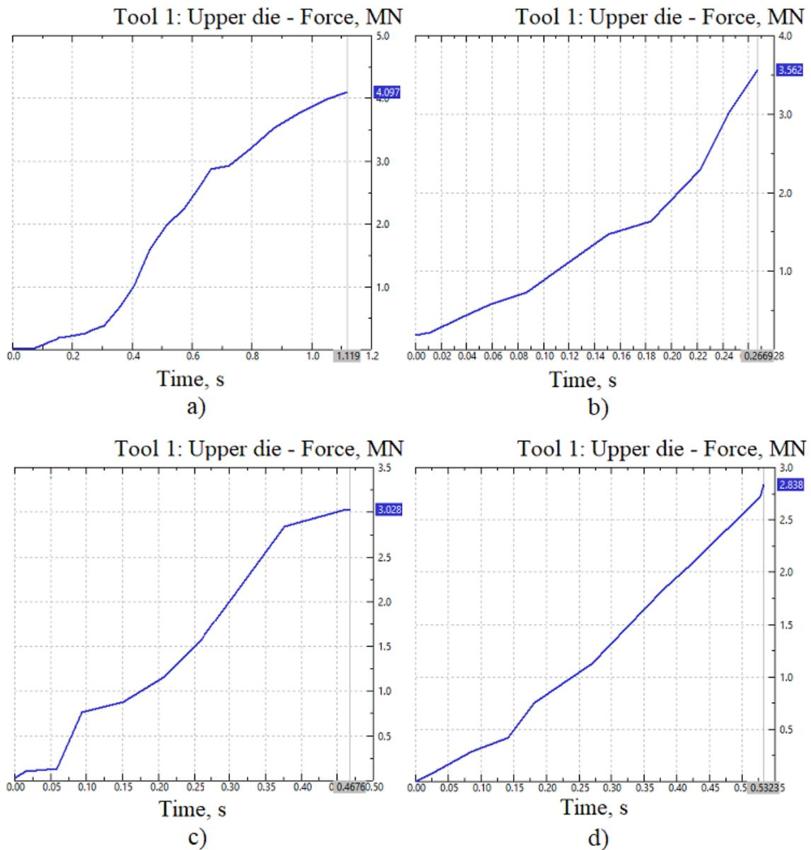
Fig. 10. Graphs of deformation force versus time for four drawing-out processes: (a)  $h/D=1, \epsilon=10\%$ ; (b)  $h/D=2, \epsilon=10\%$ ; (c)  $h/D=1, \epsilon=20\%$ ; (d)  $h/D=2, \epsilon=20\%$ .
