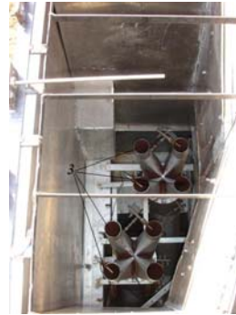
а – общий вид, б – вид на сопловой аппарат, 1 – экран смесителя, 2 – окна подвода охлаждающего воздуха, 3 – сопловые насадки Рис. 4. Модельный образец газозвдушного охладителя.
