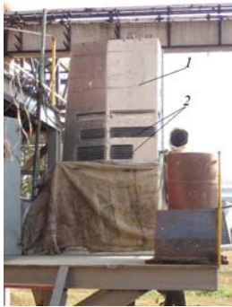
а – общий вид, б – вид на сопловой аппарат, 1 – экран смесителя, 2 – окна подвода охлаждающего воздуха, 3 – сопловые насадки Рис. 4. Модельный образец газозвдушного охладителя.
