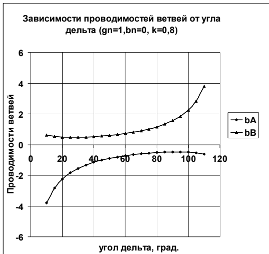
Рис.7. Зависимости проводимостей реактора и конденсатора от величины угла фазового сдвига \delta при активной нагрузке и коэффициенте преобразования k=0,8 .
