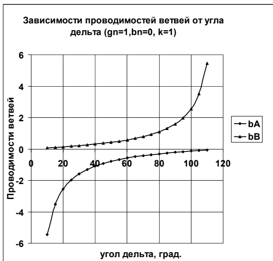
Рис.3. Зависимости проводимостей реактора и конденсатора от угла сдвига \delta между системами при активной нагрузке и k=1 .
