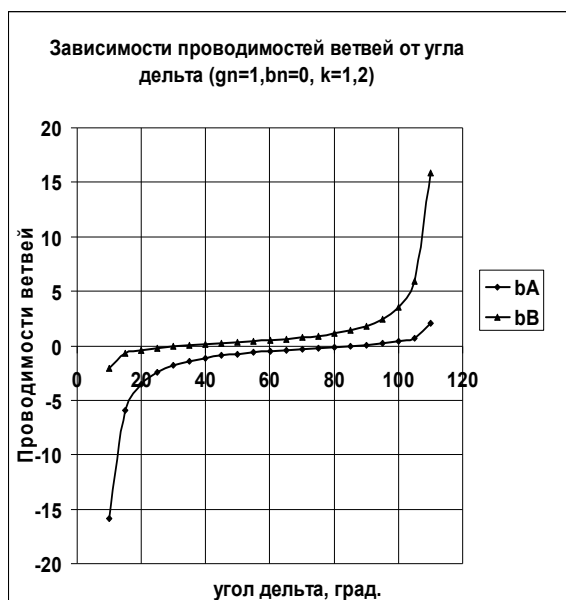
Рис.5. Зависимости проводимостей реактора и конденсатора от величины угла фазового сдвига \delta при активной нагрузке и коэффициенте преобразования k=1,2 .
