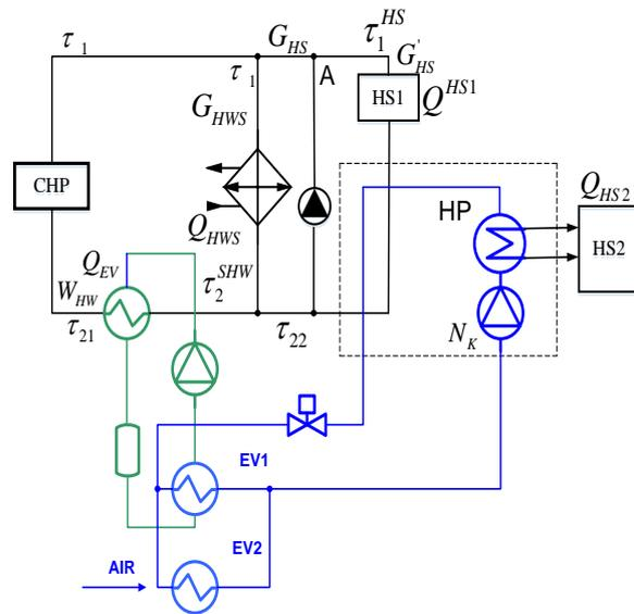
**Рис. 2. Схема ТЭЦ-ТНУ-отапливаемый объект (вариант 2).<sup>2</sup>**
