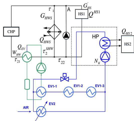
**Рис.4. Схема теплоснабжения «ТЭЦ-ТН» с повышенным SCOP ТНУ.<sup>4</sup>**
