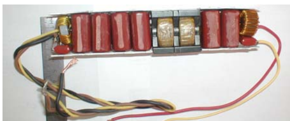
Fig. 12. Moștra convertorului cu puterea 2 kWcu alimentarea de la sursa de curent continuu cu tensiunea de 450V.
