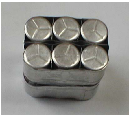
Fig. 5. Vedere a bateriei de condensatoare BS.
