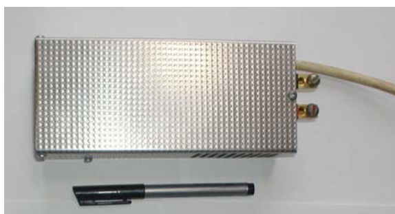
Fig. 13. Moștra convertorului cu puterea 2 kW cu alimentarea de la sursa de curent continuu cu tensiunea de 48V.
