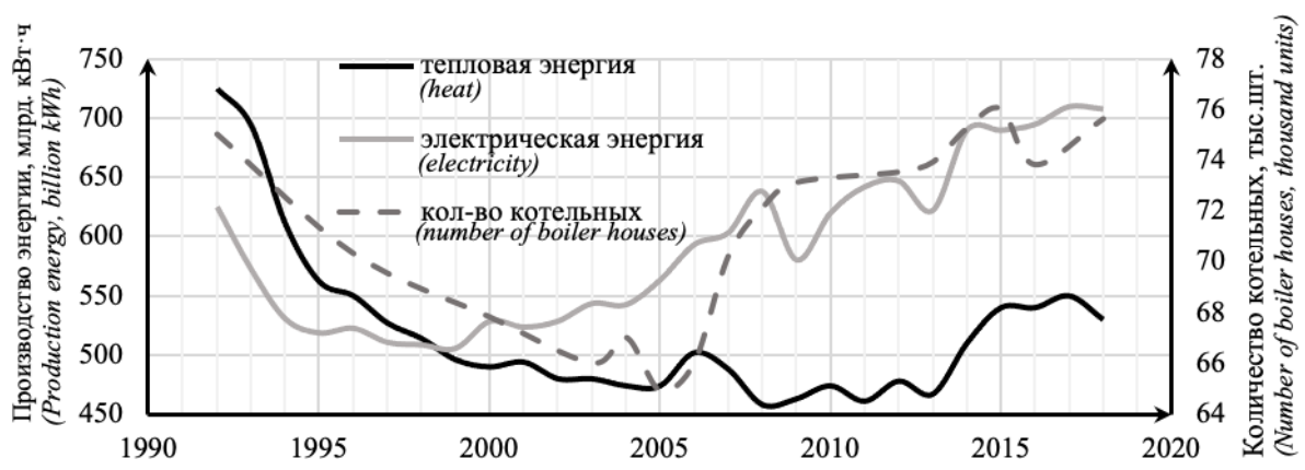
Рис. 2. Динамика изменения числа котельных на фоне производства электрической и тепловой энергии тепловыми электростанциями.
