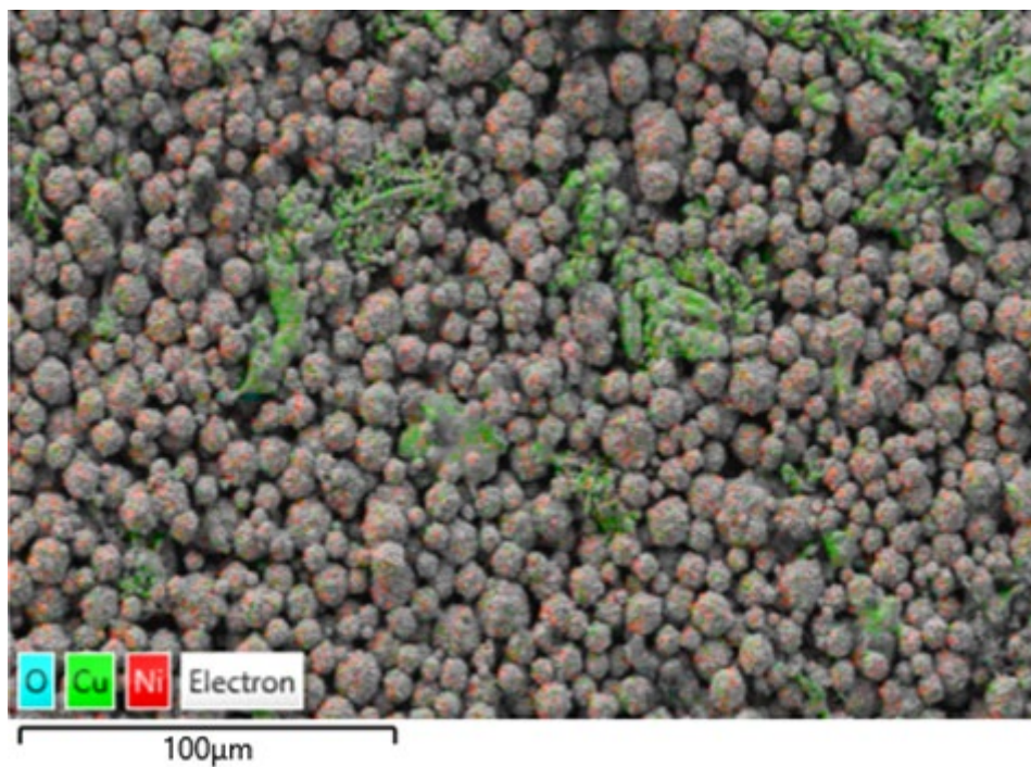
а) визуализация цветом пространственного распределения химических элементов кислорода, меди и никеля. 5
