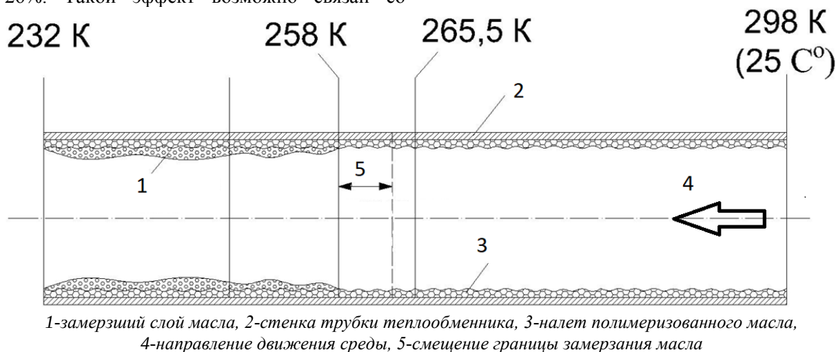
Рис. 9. Смещение границы замерзания масла при увеличении расхода потока. 19
