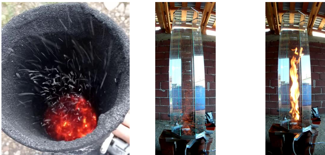
a – горение угля в камере кипящего слоя; б – режим дожигания продуктов неполного горения угля кипящего слоя; в – режим дожигания продуктов неполного горения угля с газовой подсветкой
