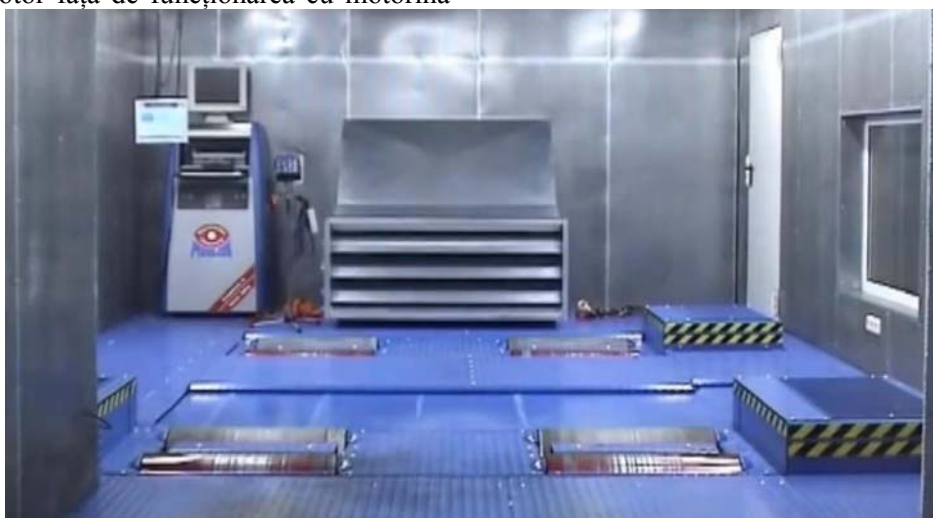
Fig. 1 Dinamometrul cu Role MAHA LPS 3000 R100
