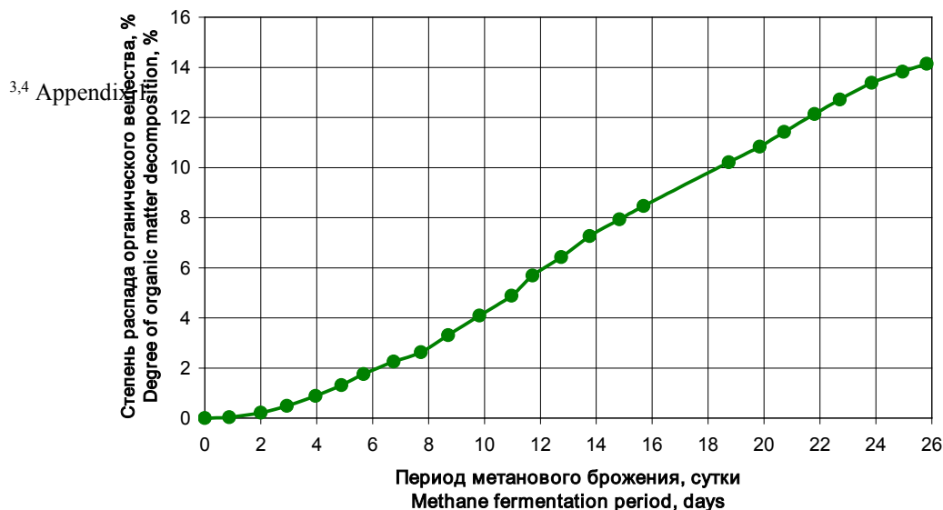
Рис. 4. Динамика распада органического вещества при сбраживании смеси навоза крупного рогатого скота с яблочными выжимками (28.1% по СОВ) в психрофильном режиме при температуре 22±1°С. 5
