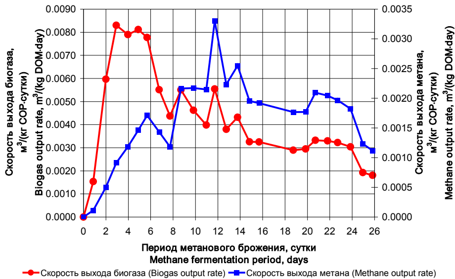
Рис. 2. Динамика изменения скорости выхода биогаза и метана при метановом сбраживании смеси навоза крупного рогатого скота с яблочными выжимками (28.1% по СОВ) в психрофильном режиме при температуре 22\pm 1^\circ\text{C} . 3
