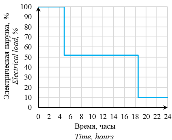
Рис.2. Пример трехступенчатого суточного зимнего графика потребителей ИСЭ. 4
