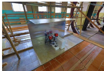
Рис. 8. Сплошной пассивный П-образный экран. 8
