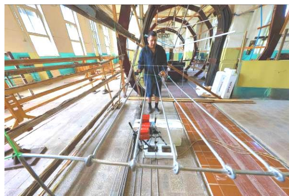
Рис.18. Многоконтурный пассивный экран экспериментальной установки, состоящий из 16 экранирующих контуров. 18
