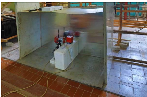
Рис. 13. Сплошной пассивный экран, у которого боковые поверхности пассивного экрана закрыты алюминиевыми листами. 13
