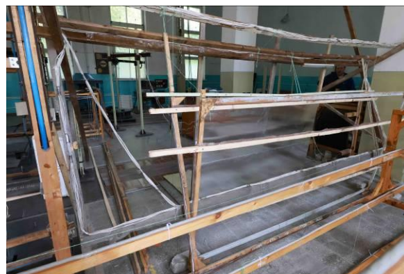
Рис. 3. Две компенсационные обмотки системы активного экранирования. 3
