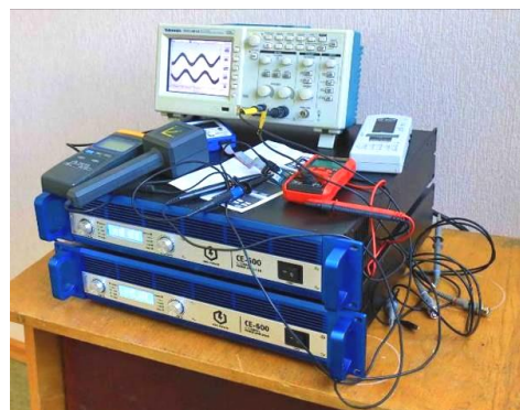
Рис. 4. Усилители мощности для питания компенсационных обмоток, с контрольно-измерительной аппаратурой. 4
