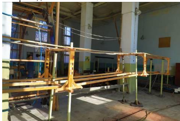
Рис. 2. Макет одноцепной ЛЭП с треугольным расположением проводов. 2
