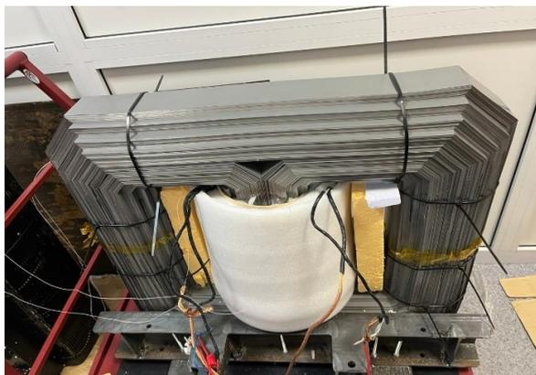
**Рис. 2. Экспериментальная модель ВТСП трансформатора с функцией ограничения тока.<sup>2</sup>**
