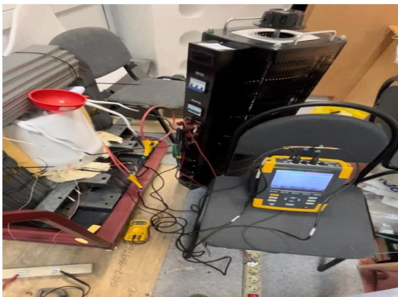
Рис. 4. Внешний вид экспериментальной сети с измерительными приборами.<sup>6</sup>
