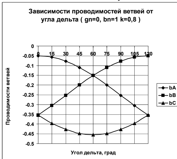
Рис.10. Зависимости проводимостей устройства от величины угла фазового сдвига \delta при емкостной нагрузке и увеличенном относительном значении выходного напряжения.
