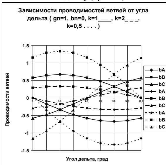
Рис.13. Зависимости проводимостей устройства от величины угла фазового сдвига \delta при активной нагрузке и при уменьшенном ( k=2 ) и увеличенном ( k=0,5 ) относительно входного значения выходного напряжения.
