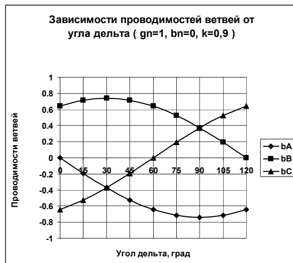
Рис.4. Зависимости проводимостей устройства от величины угла фазового сдвига \delta при активной нагрузке и коэффициенте преобразования k=0,9 .
