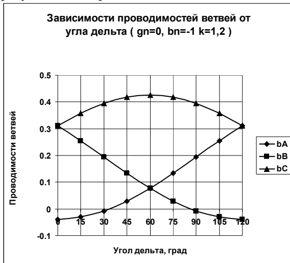
Рис.9. Зависимости проводимостей элементов реакторно-конденсаторного устройства от величины угла фазового сдвига \delta при чисто индуктивной нагрузке.
