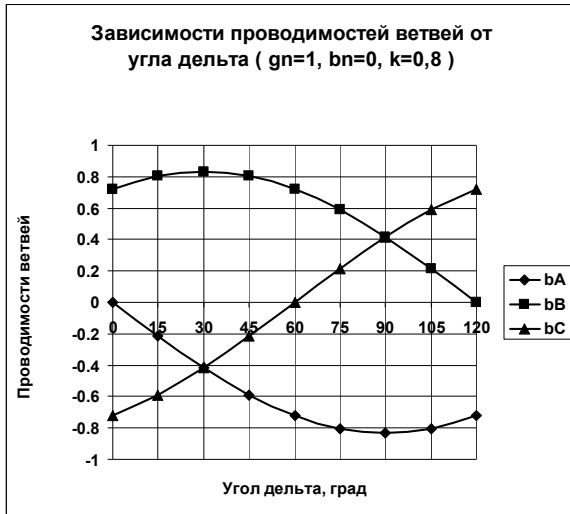
Рис.5. Зависимости проводимостей ветвей устройства от величины угла фазового сдвига \delta при смешанной нагрузке и коэффициенте преобразования k=0,8 .
