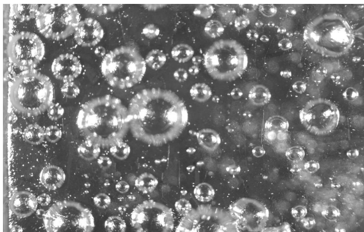
Рис. 4. Кипение воды в микканале на медном нагревателе, покрытом графеном, расход воды 10 мл/мин, температура нагревателя 112,5°C, тепловой поток 38,5 Вт/см 2 , поле зрения 7,6×5 мм 2 .
