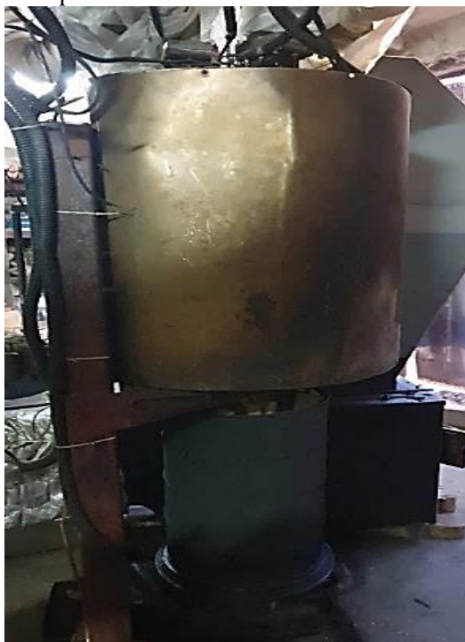
Figura 3. Procesul de încărcare a retortei cu proba de masă lemnoasă în camera reactorului.
