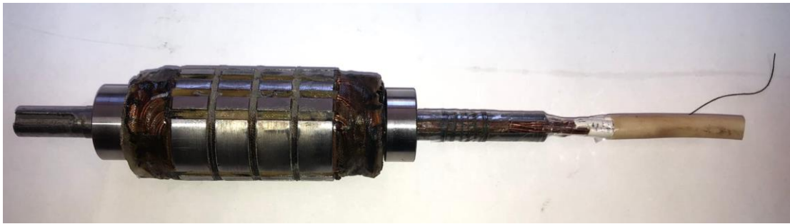
Рис. 10. Ротор модели неявнополюсного синхронного генератора
