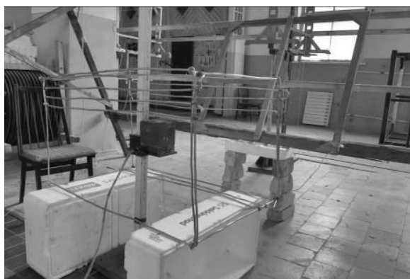
Рис.8. Многоконтурный пассивный экран экспериментальной установки электромагнитного экрана. 8
