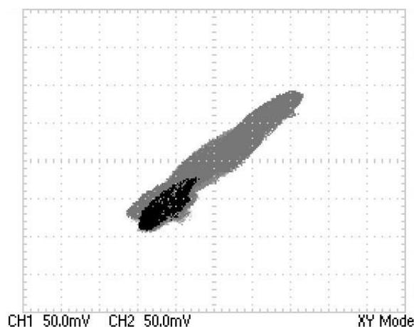
**Рис. 20. Экспериментально измеренная ПВХ результирующего МП при работе комбинированного экрана, с активным и пассивным контурным экраном.<sup>20</sup>**
