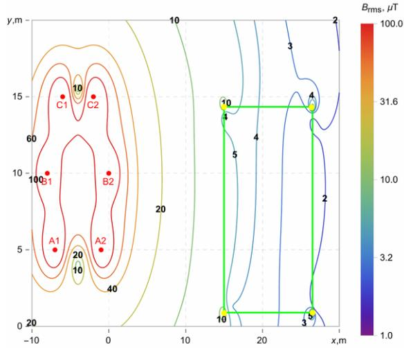
Рис. 3. Распределение средневладратического значения индукции магнитного поля при использовании только пассивного тросового контурного экрана. <sup>3</sup>
