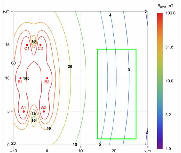
Рис. 2. Распределение среднеквадратического значения индукции магнитного поля ЛЭП вблизи жилого дома.<sup>2</sup>
