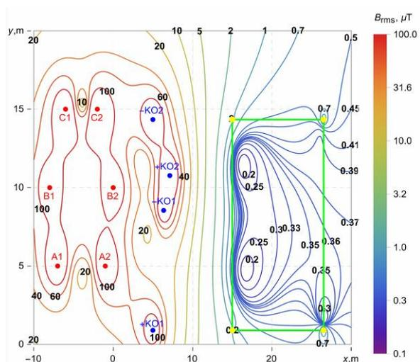
Рис.6. Распределение средневладратического значения индукции магнитного поля при использовании гибридной системы экранирования. <sup>6</sup>
