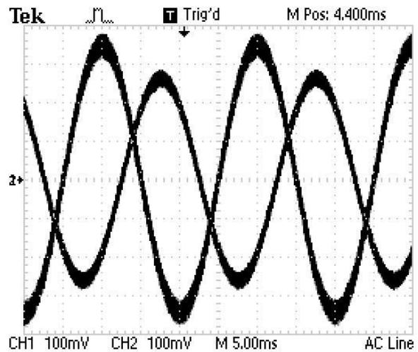
**Рис. 18.** Экспериментально измеренные выходные напряжения датчиков магнитного поля в вертикальной и горизонтальной плоскостях. <sup>18</sup>
