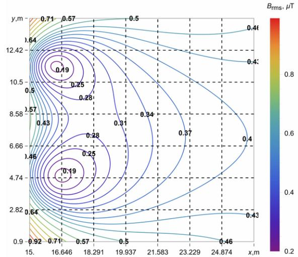
Рис. 5. Детальное распределение средневладратического значения индукции магнитного поля внутри жилой зоны при использовании только активного экрана. <sup>5</sup>
