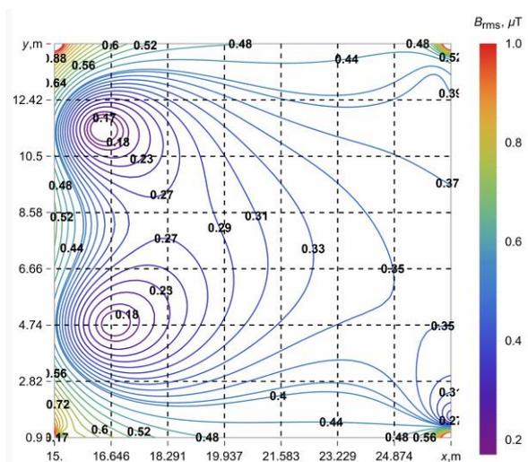
**Рис. 7. Детальное распределение средневладратического значения индукции магнитного поля внутри жилой зоны при использовании гибридной системы экранирования.<sup>7</sup>**
