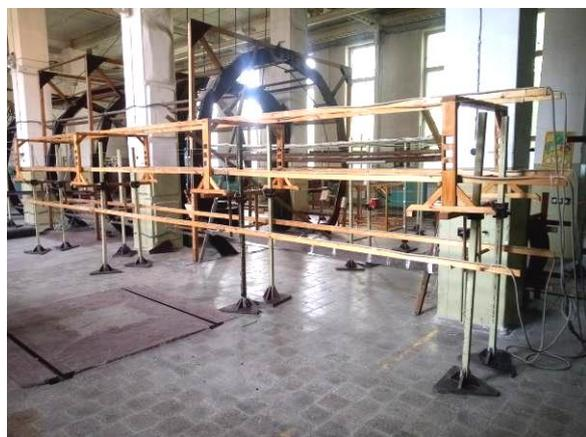
**Рис. 8. Двухцепная линия электропередачи с расположением проводов типа «бочка» макета экспериментальной установки.<sup>8</sup>**
