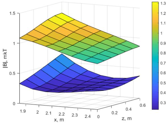
**Рис. 16.** Экспериментально измеренные распределения исходного и результирующего МП при работе комбинированного экрана. <sup>16</sup>
