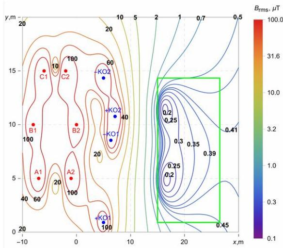
Рис. 4. Распределение средневладратического значения индукции магнитного поля при использовании только активного экрана. <sup>4</sup>
