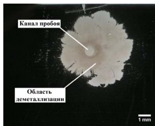
Рис.1. Зона деметаллизации электрода конденсатора после пробоя диэлектрика.
