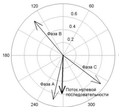
**Рис. 10.** Относительные значения потоков в стержнях при ДКЗ с землей
