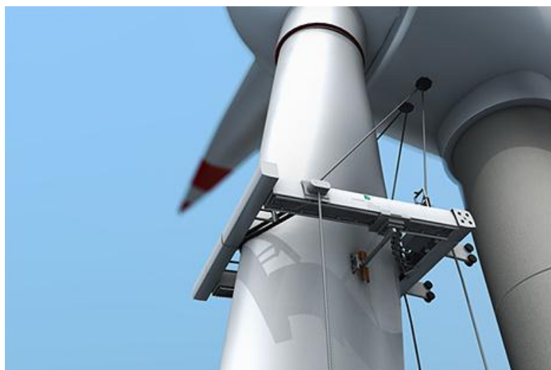
Рис. 1. Схема робота для инспектирования состояния ветровых турбин
