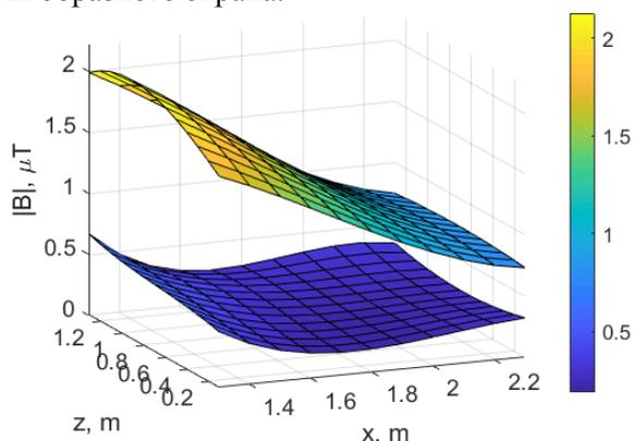
**Рис. 19. Экспериментально измеренные распределения исходного и результирующего МП при работе комбинированного экрана.**<sup>19</sup>
