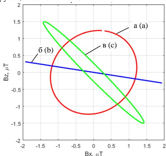
Рис. 10. ПВХ результирующего МП при работе только второй компенсирующей обмотки САЭ.<sup>10</sup>
