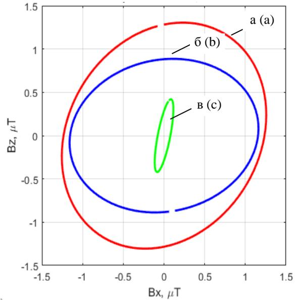
Рис. 8. Пространственно временные характеристики исходного МП а), магнитного поля, генерируемого двумя компенсирующими обмотками б) и результирующего МП в). <sup>8</sup>
