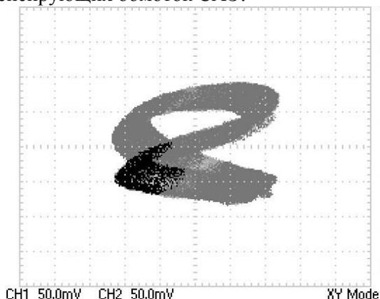
**Рис. 24. Экспериментально измеренная ПВХ результирующего МП при одновременной работе первой и второй компенсирующих обмоток САЭ.<sup>24</sup>**
