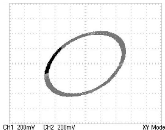
**Рис. 21. Экспериментально измеренная ПВХ исходного МП.**<sup>21</sup>
