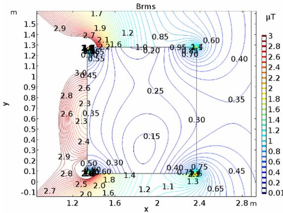
Рис. 5. Распределение результирующего МП при работе только пассивного экрана. <sup>5</sup>
