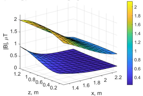
**Рис. 17. Экспериментально измеренные распределения исходного и результирующего МП при работе только САЭ.**<sup>17</sup>
