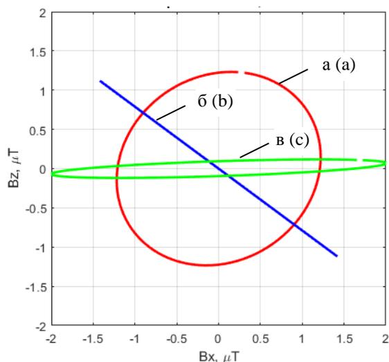
Рис. 9. ПВХ результирующего МП при работе только первой компенсирующей обмотки САЭ.<sup>9</sup>
