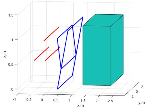
Рис. 3. Расчетная схема расположения проводов одноцепной ЛЭП и многоэтажного дома.<sup>3</sup>
