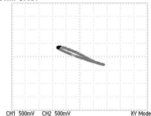
**Рис. 23. Экспериментально измеренная ПВХ результирующего МП при работе только второй компенсирующей обмотки САЭ.**<sup>23</sup>
