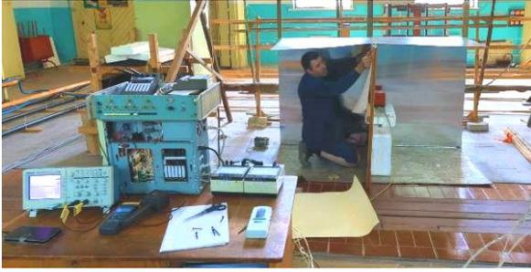
**Рис.14. Блок управления САЭ макета экспериментальной установки.**<sup>14</sup>
