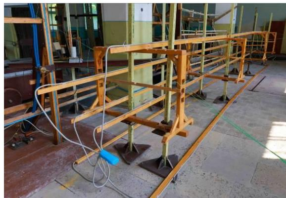
Рис. 11. Макет экспериментальной установки одноцепной ЛЭП с треугольным расположением проводов.<sup>11</sup>
