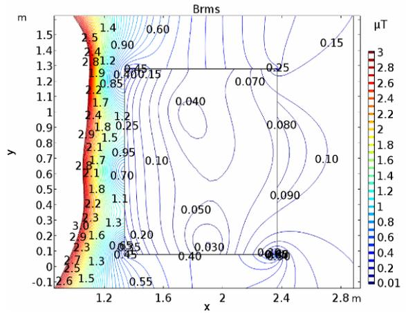
Рис.7. Распределение результирующего МП при работе комбинированного экрана, включающего активный и П-образный пассивный экран. <sup>7</sup>
