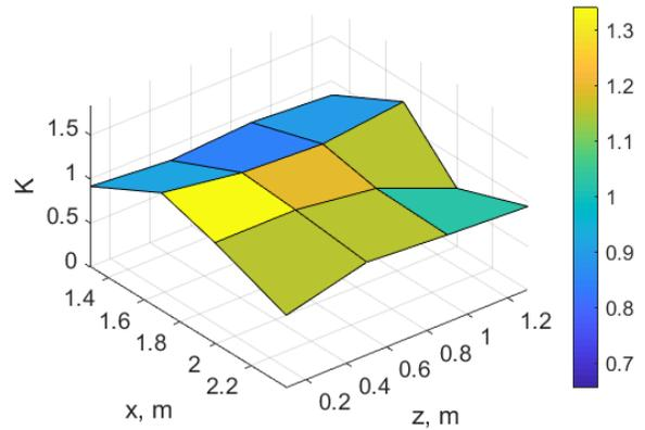
**Рис. 16. Экспериментально измеренное распределение ФЭЭ исходного МП при работе пассивного сплошного П-образного экрана.**<sup>16</sup>
