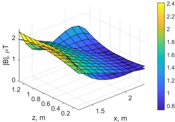
**Рис. 15. Экспериментально измеренные распределения исходного МП и результирующего МП при работе только одного пассивного сплошного П-образного экрана.**<sup>15</sup>
