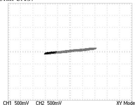
**Рис. 22. Экспериментально измеренная ПВХ результирующего МП при работе только первой компенсирующей обмотки САЭ.**<sup>22</sup>
