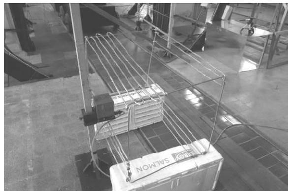
**Рис.8. Многоконтурный пассивный экран экспериментальной установки гибридного активно- пассивного экранирования.<sup>8</sup>**
