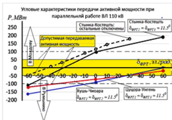
Рис. 11. Режим параллельной работы ВЛ 110кВ.
