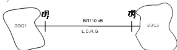
Рис.3. Эквивалентная схема межсистемной связи.
