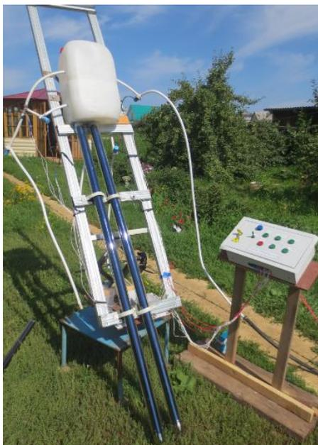
**Рис. 3.** Фотография солнечной опреснительной установки
